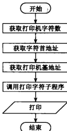
图 6-12 编程程序 2 流程图
